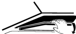
Stecken Sie den Aktivkohlefilter in das Gerät und drehen Sie ihn im Uhrzeigersinn. Wiederholen Sie dasselbe auf der anderen Seite.
